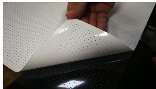
WTF98反射膜(0.19mm)带背胶打孔样品
