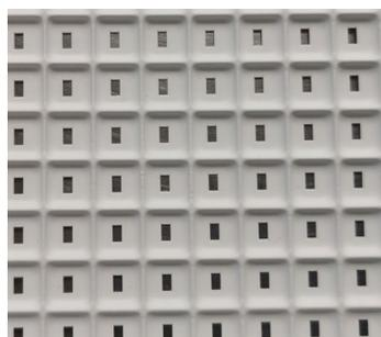
WTF98反射膜(0.19mm)吸塑成型样品
